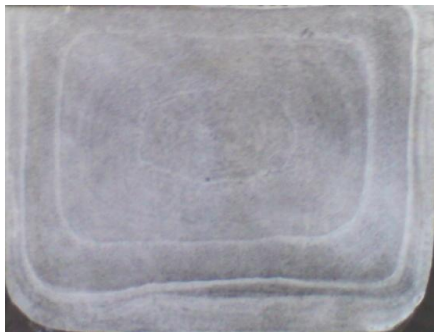
Рис.7.20. Макроструктура поковки из слитка ВДП. Сталь 12Х2Н4А. Диаметр слитка 500 мм, электрод кв 320 мм; переплав при 10 кА; сечение поковки – кв.200 мм. Поперечный темплет.
