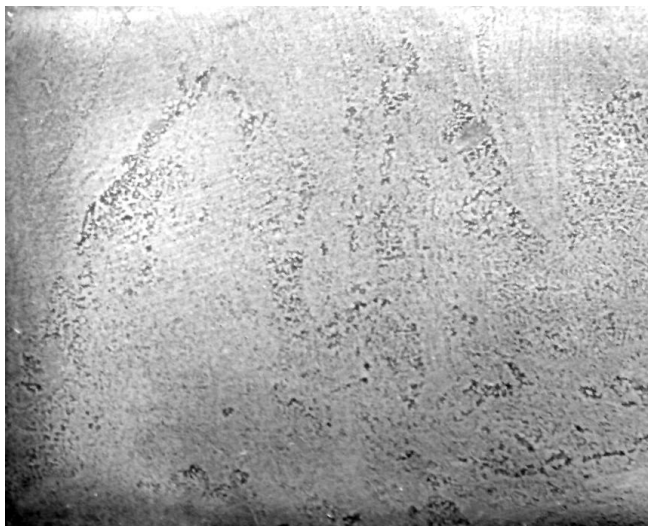
Рис.7.16. Фрагмент дендритного строения слитка стали ШХ15. Кристаллизатор \varnothing 130 мм, 1,5 кА, переплав с вынесенной дугой.
