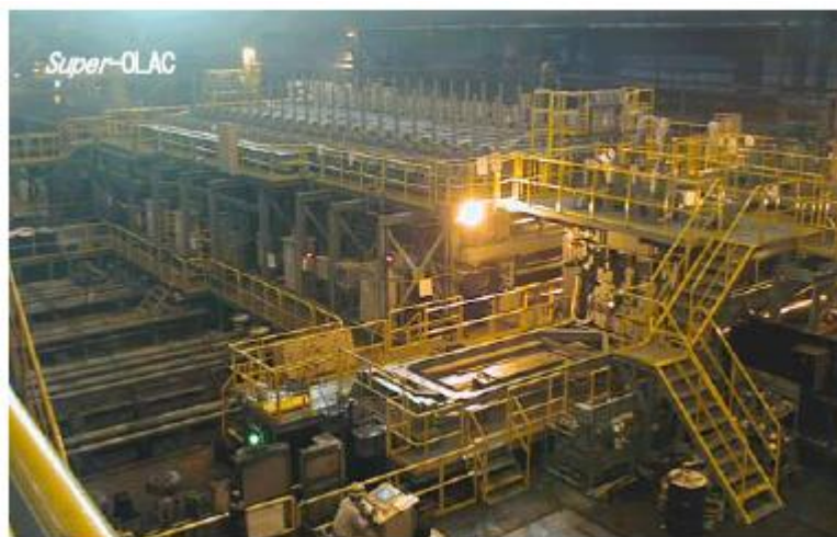
Фото 1. Технология Super-OLAC (изготовление толстолистовой стали)
