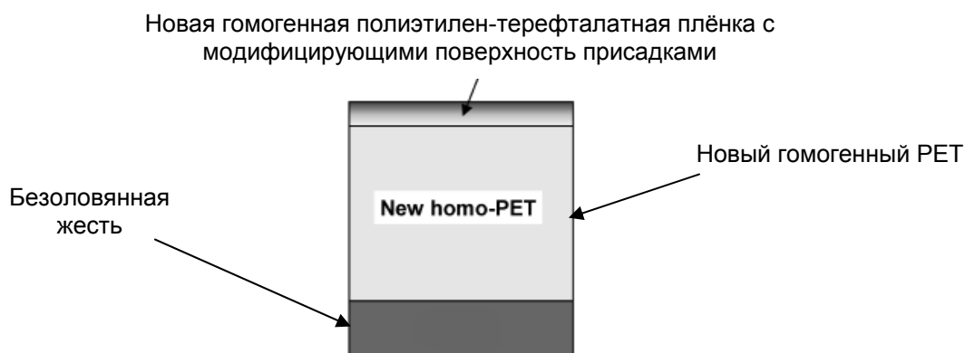
Поперечный разрез нового покрытия листовой стали для консервной тары
